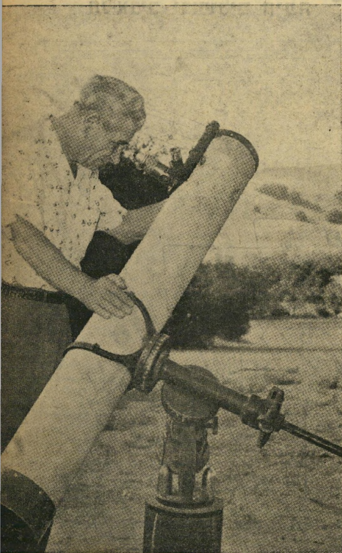
צלם מול צלחת: אחד מהטלסקופים בהם השתמש ג'ורג' אדמסקי לצילום הצלחות. את צילומיו ביצע מעל לעדשת הטלסקופ, בעלת הקוטר של חמשה-עשר סנטימטרים כשהמצלמה מותקנת במקום עדשת העין.
